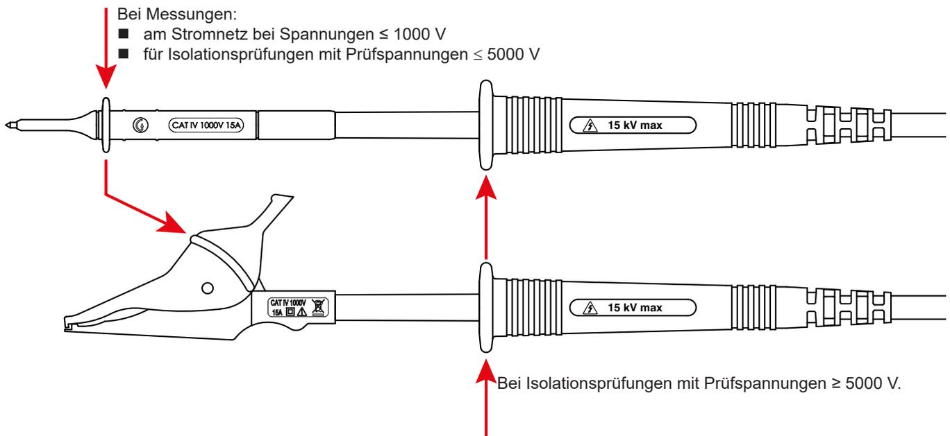
Messungen am Stromnetz bei Spannungen  $\geq 1000$  V dürfen nur mit Prüfspitzen ausgeführt werden und der Bediener darf diese nur hinter dem Griffschutzkragen anfassen.
