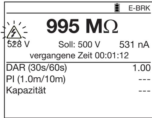
Im Falle einer Messung mit Spannungsstufen (10 Stufen maximal) oder einer Spannungsrampe (mit 3 Rampen-Abschnitten) wird der Fortschritt der Stufen und die restliche Prüfdauer angezeigt.
