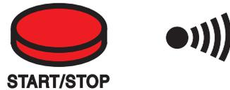
Sobald die geforderte Prüfspannung 5 000 V überschreitet, blinkt die START/STOP-Taste rot.
