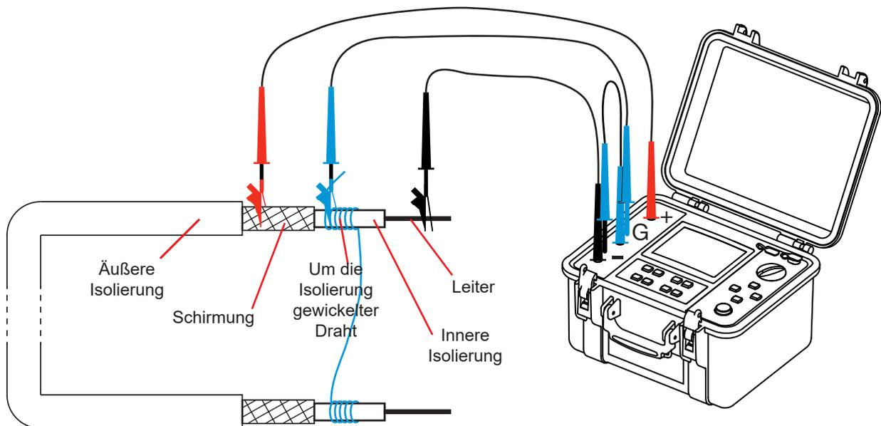
Die Benutzung der Buchse G verhindert Messfehler durch Oberflächen-Leckströme. Wickeln Sie einen blanken Draht um die Isolierung.
