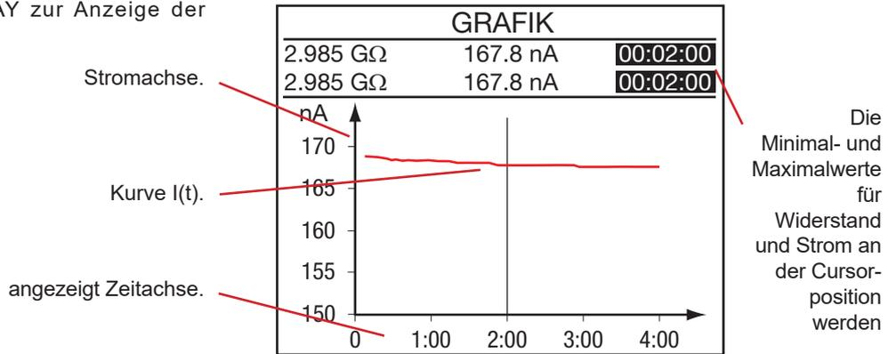
Drücken Sie wiederum die Taste DISPLAY zur Anzeige der Stromkurve über der Spannung (gilt nicht für U-STEP).
