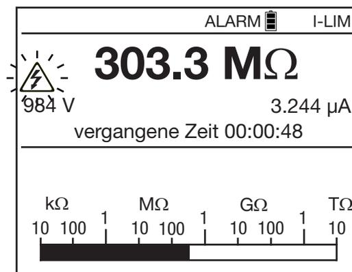
Diese Funktion ist nützlich, wenn die digital angezeigten Messwerte sehr unstabil sind. Die Analogdarstellung des Messwerts am Bargraph lässt allerdings auch eine gute Abschätzung des Messergebnisses zu.
