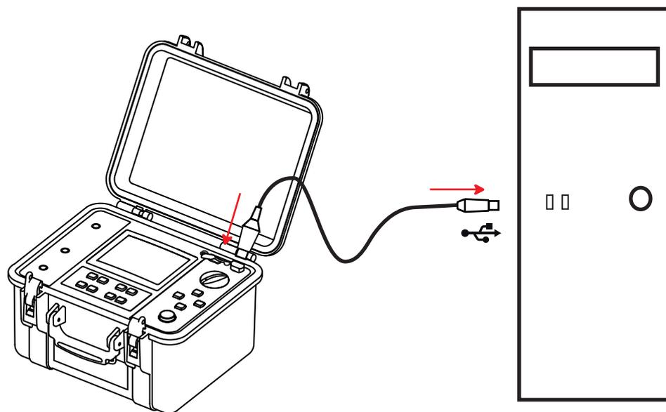
Wenn das Gerät mit einem PC verbunden ist, erscheint in der Anzeige REMOTE und eine Bedienung am Gerät ist nicht möglich, da alle Tasten und der Drehschalter inaktiv sind. Das Gerät lässt sich nur noch mit Drehschalterstellung OFF abschalten. Um die Datenübertragungs-Software zu verwenden, lesen Sie bitte in der Online-Hilfe nach.
