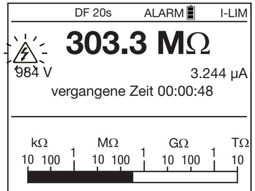
Die Auswahl der digitalen Filterung empfiehlt sich, wenn hohe Isolationswiderstandswerte stark schwankend angezeigt werden. Diese Schwankungen können hervorgerufen werden durch Berührungen mit der Hand, veränderliche Kapazitäten im geprüften Gegenstand, unterschiedliche Oberflächenwiderstände durch leitende Staubschichten, Ionisierungs- oder Polarisierungseffekte dieser Staubschichten, sowie schließlich durch anliegende Fremd-Wechselspannungen.
