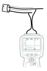
Schließen Sie die Prüfleitung an das zu prüfende Kabel an. Die Verbindung kann mit einem unter Spannung stehenden System mit Spannung gegen Masse (Erde) unter 150 V bei einer Installation (Überspannung) der Kategorie IV oder darunter hergestellt werden. Das bedeutet, dass das Instrument auch an primäre Versorgungsstromkreise angeschlossen werden kann, z. B. Freileitungen. Die Spannung muss 300 V zwischen den Anschlussklemmen und 150 V CATIV an Erde betragen.
